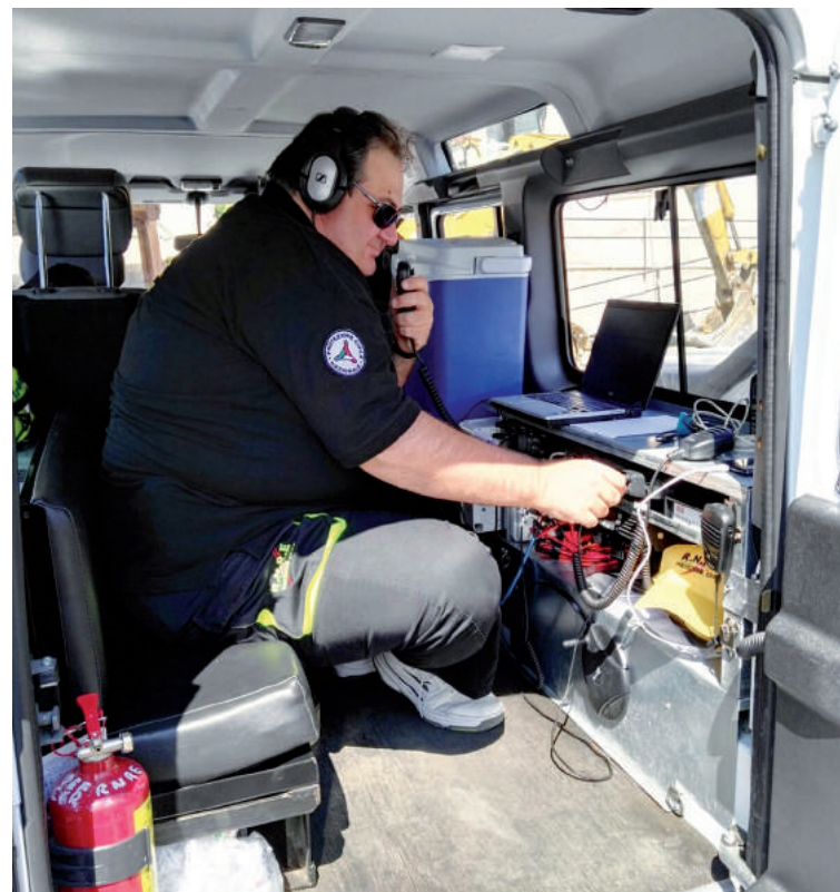
■ Trasmissioni radio da una Unità Mobile RNRE attrezzata per operare in tutte le modalità: satellitare, digitale fonia
